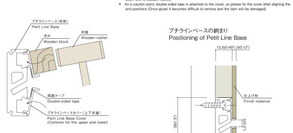
プチラインシステムの施工方法 Construction Method for Petit Line System
