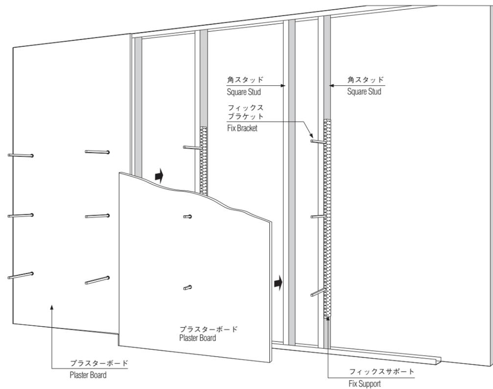
棚下照明用コードブラケットの施工方法
